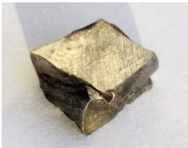
**Рис. 6. Образец с трещиной после испытания предела прочности при сжатии**
